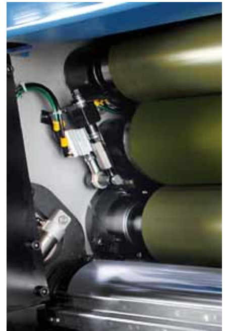
Ein Alleinstellungsmerkmal der KBA Compacta neuester Generation mit sehr positiven Auswirkungen auf die Wartungsintensität und den Energieverbrauch sind die automatisierten Walzenschlösser. Foto: KBA
